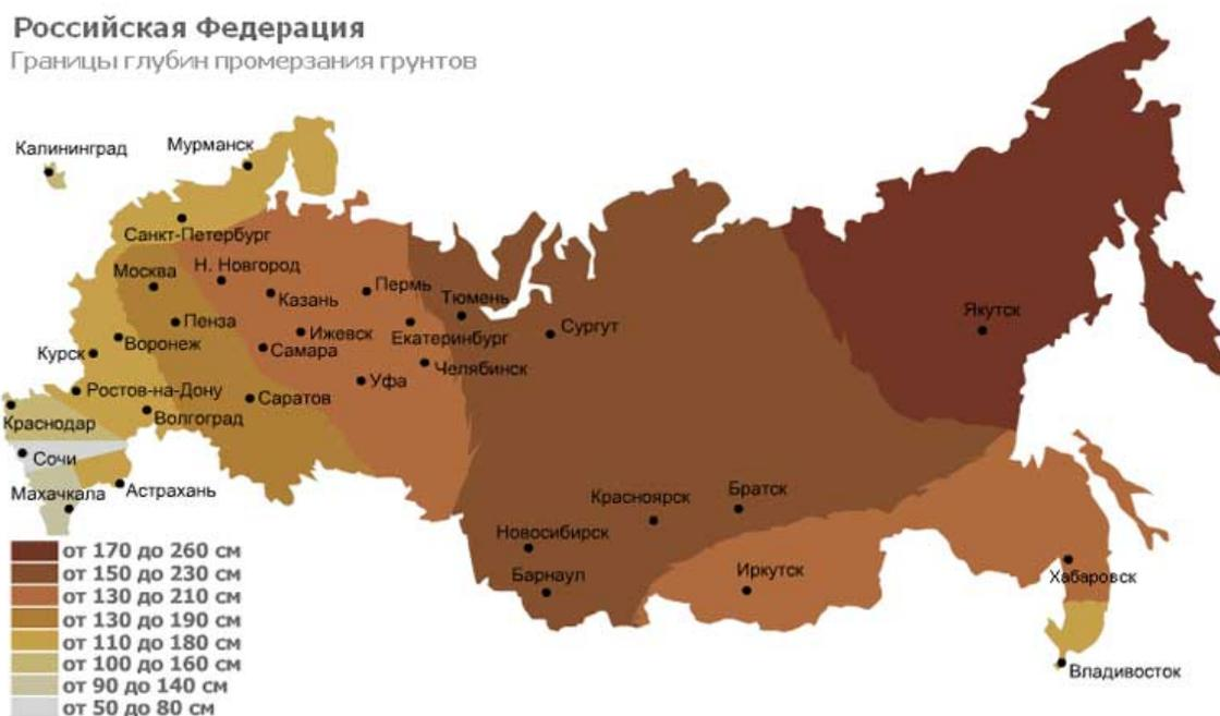
Рисунок 1.1.1 – Глубины промерзания грунтов
